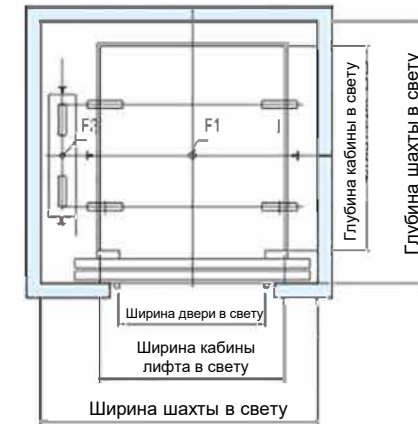
Горизонтальная проекция шахты
